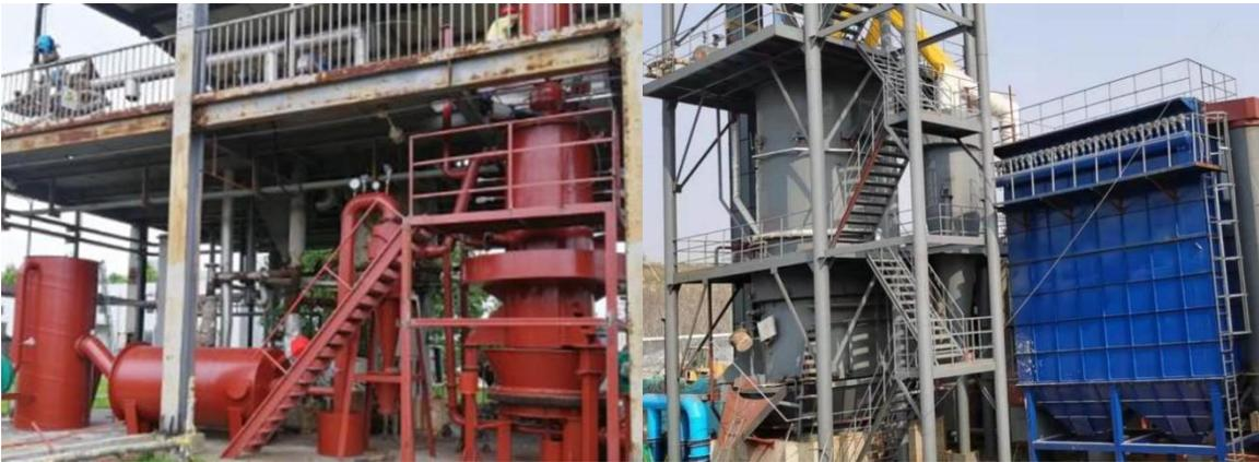
图2 热解气化中试设备（左）及产业化设备（右）
