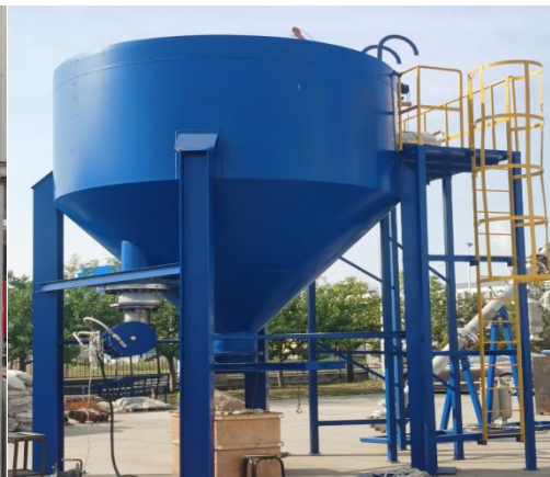
十万吨级快速卸料装置
